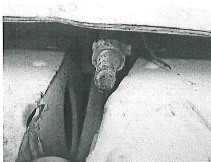
Daño al soporte de la barilla de control del flap del ala izquierda facturado desde su base
